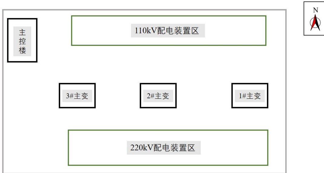
图 10 林州 220kV 变电站总平面布置示意图
