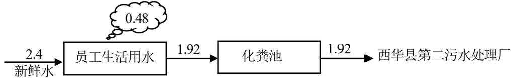
图1 本项目水平衡图（单位：t/d） 散失量：
