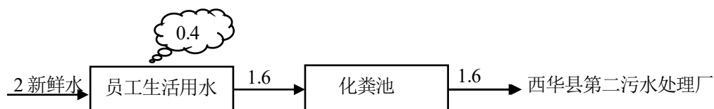
图 1 本项目水平衡图（单位：t/d） 散失量：0.4
